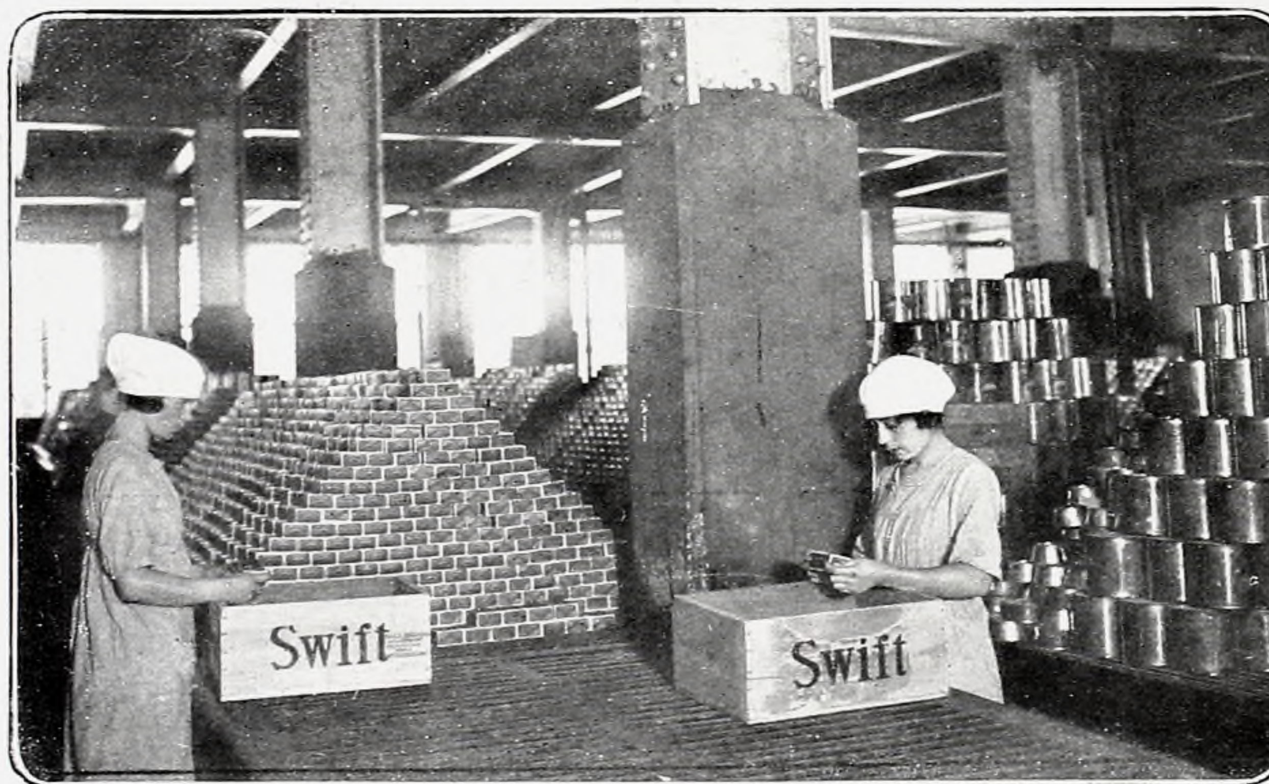
Los productos envasados en latas son retenidos en observación algún tiempo para constatar si existiera escape en algunas de ellas o si se hubieran hinchado. Una vez pasada esta inspección, las latas son pintadas y se colocan las etiquetas. Antes de ser encajonadas cada lata es inspeccionada ocularmente para subsanar cualquier defecto que pudiera existir y ocasionar dificultades en la venta.
