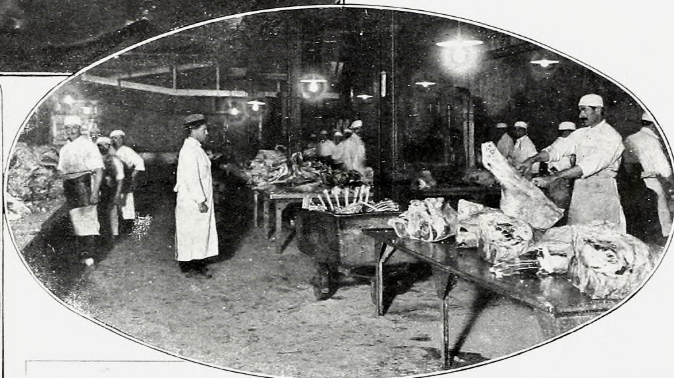
Después de sacrificado el animal y haber sido sometido a la inspección veterinaria, la res pasa a la cámara frigorífica para su enfriamiento. Cuando está convenientemente enfriada, pasa al departamento correspondiente, donde se procede a cortar y seleccionar los trozos de carne que se utilizarán en la elaboración de las conservas.
