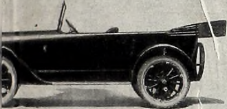
"Dodge". — Tipo especial. Motor de 4 cilindros. Válvulas a la cabeza. Facón para 5 personas. Arranque y alumbrado eléctrico.
