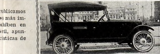
"Cleveland". — Motor de 6 cilindros. Magneto Bosch. El automóvil más chico de 6 cilindros. Para 5 pasajeros.
