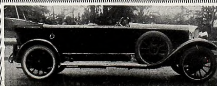
"Hansa Lloyd". — Motor de 4 cilindros. 35-45 H.P. Coche doble facón de 7 asientos.
