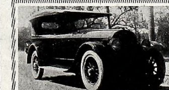
"Opel". — Motor de 4 cilindros, a magneto. Arranque y alumbrado eléctrico. Doble facón de 5 asientos.
