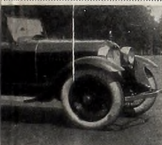
"Ford". — Motor de 8 cilindros provisto de frenos a 4 ruedas. Facón de carrocería de aluminio.
