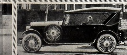
"Lexington". — Motor de 6 cilindros. Válvulas a la cabeza. 35-45 H.P. 5 asientos. Doble facón tipo sport.
