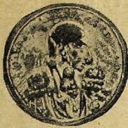
Anverso y reverso de una medalla de bronce del siglo XVII, atacada de la peste del estaño
