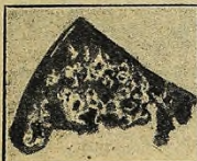
Trozo de techo del Hotel de Ville, de Rotherburg, atacado de la peste del estaño
