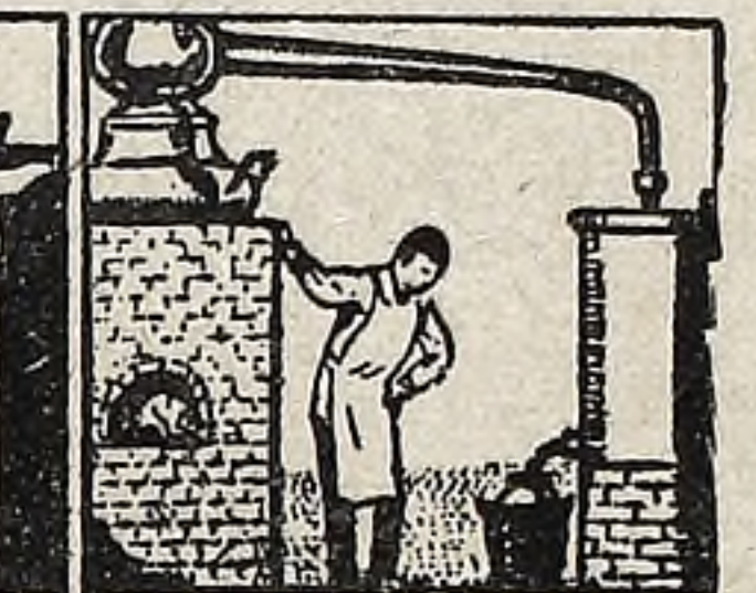
La madera destilada, a secar en retorta, desprende un líquido del que se separa por decantación el espíritu de madera o alcohol metílico. Este espíritu se emplea como combustible, como disolvente de resinas para barnices, etc. Oxidándolo se obtiene formol.
