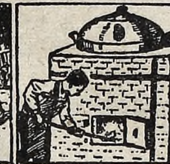
La madera carbonizada en caldera o en recipiente cerrado, da un carbón que sirve para la fabricación de pólvora. Tratada químicamente por el ácido azótico, se obtiene un piróxilo de madera, análogo al fulmi-algodón, pólvora de cata o de guerra.
