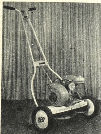
Uno de los más recientes modelos de cortadora de césped, con un motor de caballo y medio de fuerza de velocidad variable y arranque automático, que tiene llantas de goma y que puede ser detenida instantáneamente mediante el toque de un botón.
